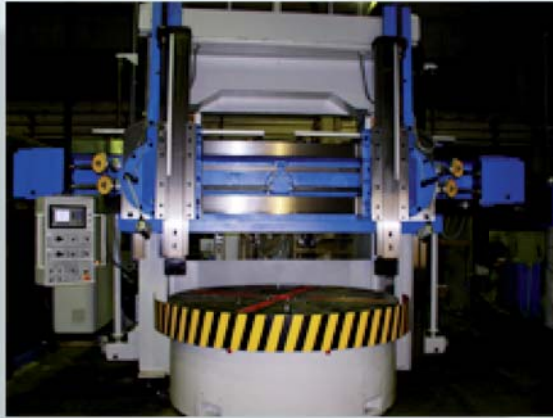
Abb.1) Doppelständer-Karusselldrehmaschine, Ausführung mit zwei Supporten zzgl. Option-Seitensupport
