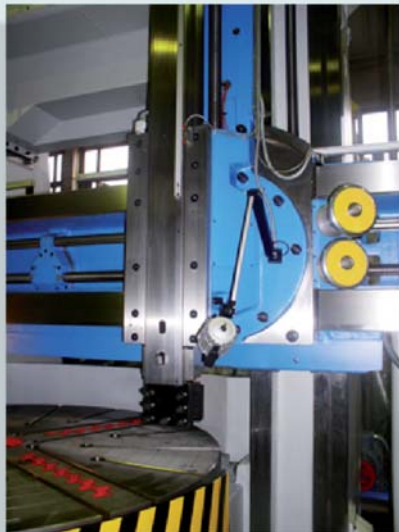
Abb.2) Doppelständer-Karusselldrehmaschine, Ausführung mit Dreifach-Stahlhalter, Optional mit Revolverkopf
